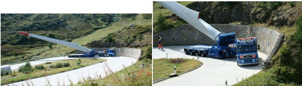
Abbildung 3: Spezialtransport für eine Windenergieanlage (CH)
