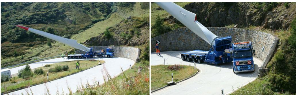
Abbildung 3: Spezialtransport für eine Windenergieanlage (CH)
